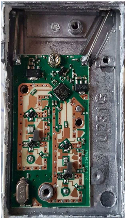
LNB GOLDEN MEDIA GM 202-V3 mit RT330 Chip – Umgebaut
