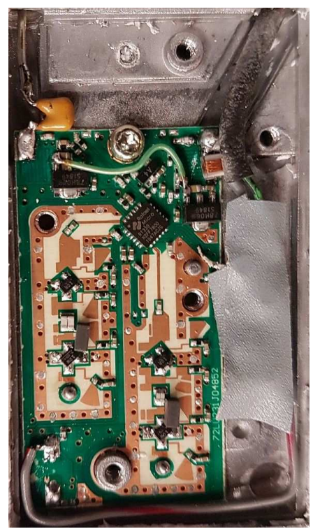
LNB GOLDEN MEDIA GM 202-V3 mit RT330 Chip – Umgebaut
