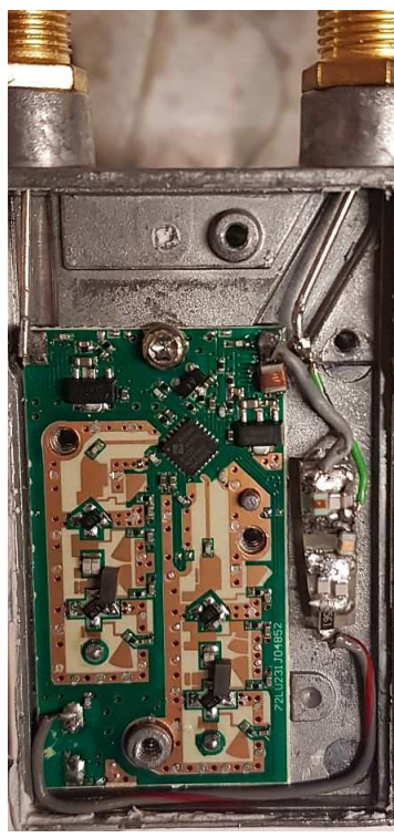
LNB GOLDEN MEDIA GM 202-V3 mit RT330 Chip – Umgebaut
